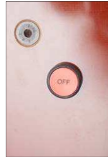
Fig. 18 – Botón de parada (STOP) de emergencia en el frente de la bobina
