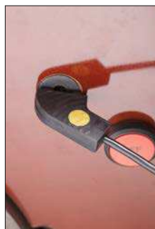
Fig.15 – Anbring den magnetiske sensor på en metallisk overflade såsom en bolt på EAZ
