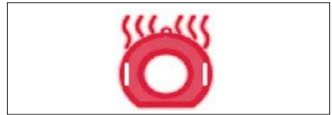
Fig. 17 – Símbolo de advertencia de bobina demasiado caliente
