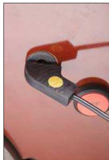
Fig. 15 – Colocação da sonda magnética em uma superfície metálica, como um parafuso na EAZ
