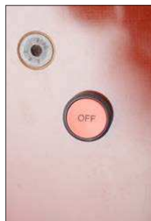
Рис. 18 Кнопка аварийного останова на передней стороне катушки
