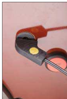
Рис. 15 Поместите магнитную термопару на металлическую поверхность, например, на болт устройства EAZ
