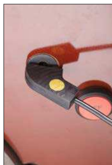
Fig.15 – Placez la sonde magnétique sur une surface métallique, par exemple un boulon, sur l'EAZ
