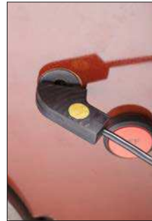
图 15 - 将磁性探头放在金属表面（例如 EAZ 上的螺栓）上
