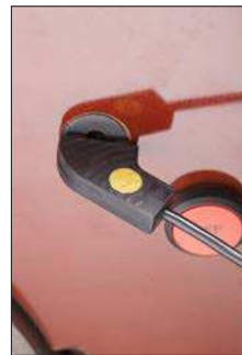
Fig. 15 – Coloque la sonda magnética sobre una superficie metálica, tal como un tornillo en el EAZ
