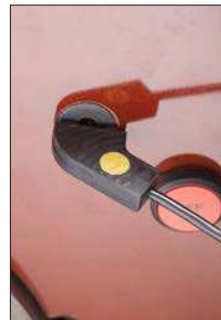
Bild 15 – Den magnetischen Fühler an einer Metallfläche anbringen (z. B. an einer Schraube am EAZ).
