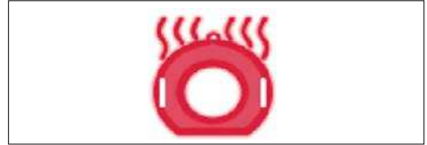
图 17 - 线圈温度过高警告符号
