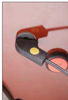
Fig.15 – Posizionare la sonda magnetica su una superficie metallica, come un bullone sull'EAZ
