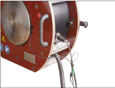
Fig.8 – Réglez la longueur du câble de la sonde de température au minimum pour éviter d'endommager la sonde.
