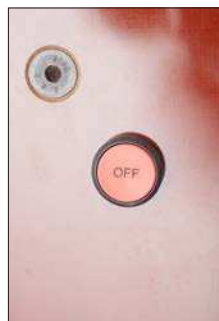
Fig. 18 – Botão STOP (Parar) de emergência localizado na frente da bobina
